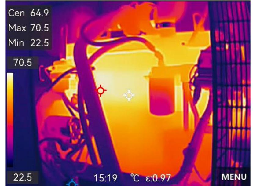
Résistance électrique de 1 000 W avec un fonctionnement H24/7J
